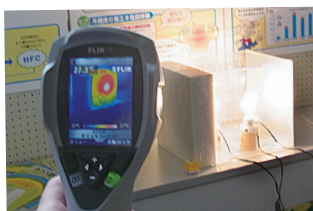
サーモカメラを活用した断熱性能比較
