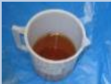
廃電気機器由来の 絶縁油（廃油）
