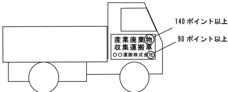
図 3.4.3 収集運搬車両への標識例
