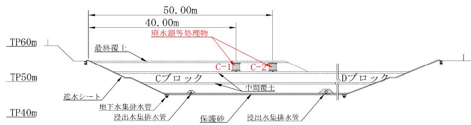
図 3.7.9 埋め立てた廃水銀等処理物の埋立位置の記録例（a-a 断面図）
