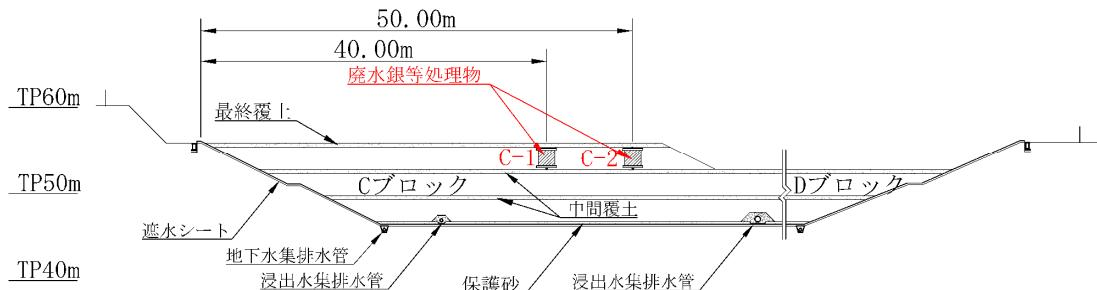
図 3.7.8 埋め立てた廃水銀等処理物の埋立位置の記録例（a-a 断面図）
