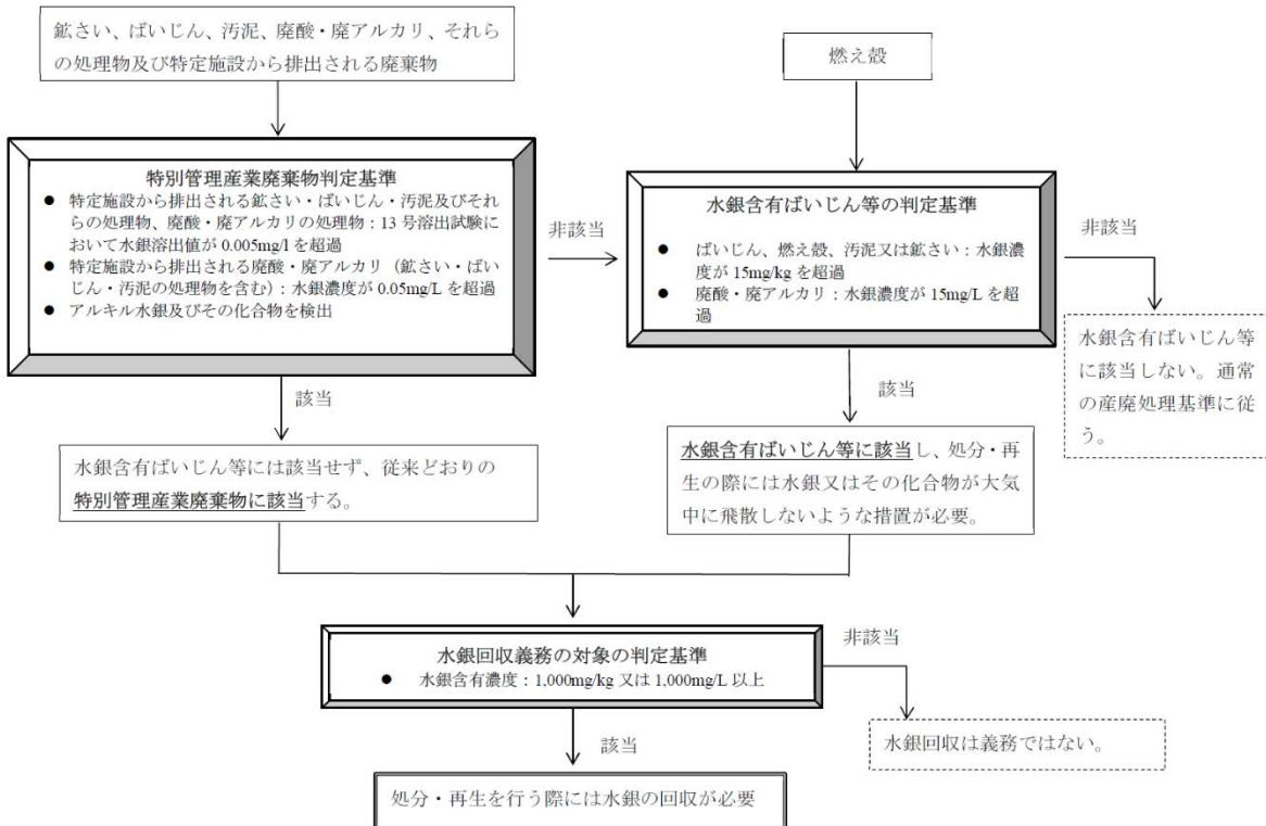
図 4.1.1 水銀汚染物の分類及び必要な措置
