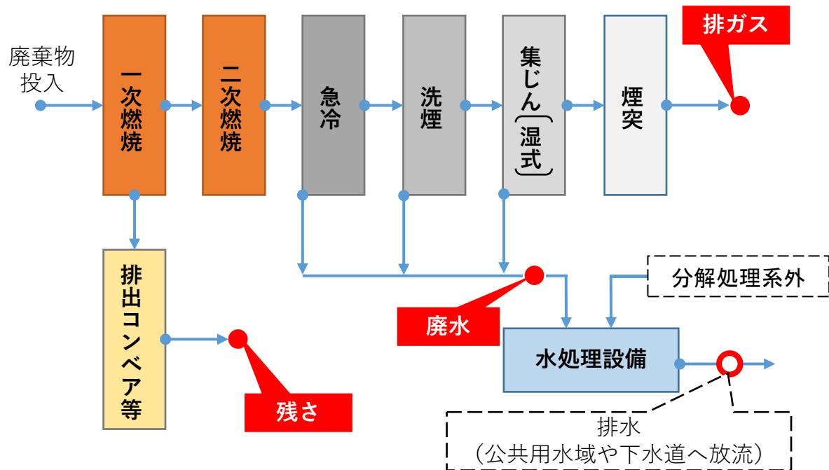
図2 焼却炉の構造と廃水のイメージ
