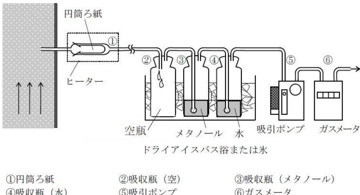
図 5-1. 排ガス試料採取装置の一例
